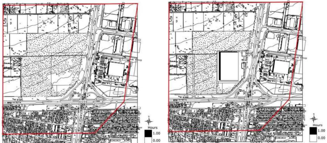
Figura 245 – Análise de sombreamento – Total de horas de sol incidentes no período de 21/12 às 09h – Cenários I (sem o empreendimento) e II (com o empreendimento).
