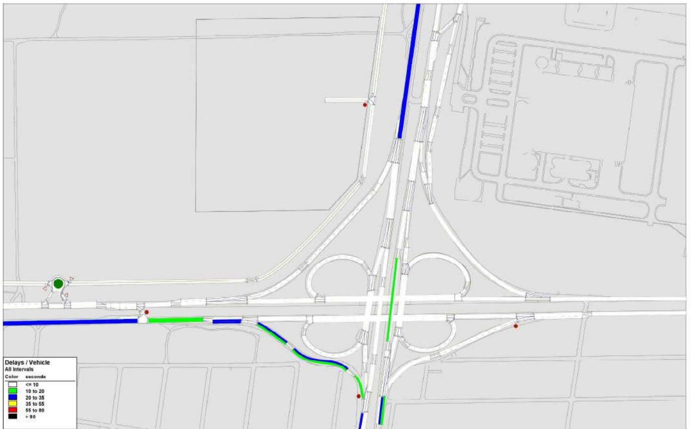
Figura 181 – Atrasos nas aproximações com o empreendimento instalado no período da manhã – Cenário 02 – trecho 01
