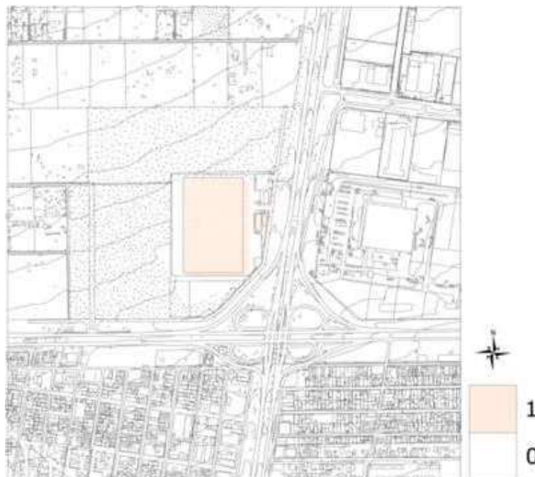
Figura 236 – Diagrama comparativo de sombreamento – Diferença de horas de sol incidentes com e sem o empreendimento no período de 21/06 às 15h – Comparativo entre os Cenários I e II.
