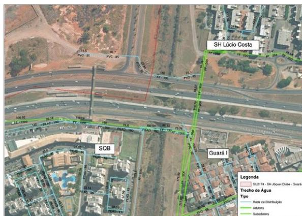
**Figura 07:** Rede de abastecimento de água existente que interfere com a poligonal do empreendimento.
