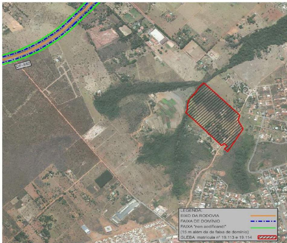
Figura: Croqui das faixas de domínio e não edificante da rodovia mais próxima em relação à gleba. Fonte: DER
