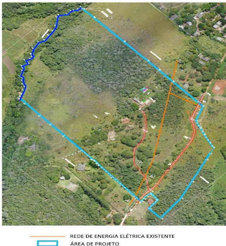
Figura: Croqui de interferência da rede pública de energia com a gleba. Fonte: MDE EP
