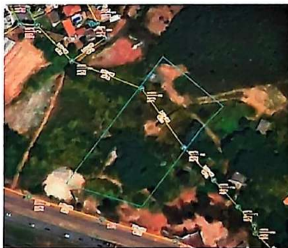
Interferência com rede de esgotamento – EPC Poligonal 08 Plano.
