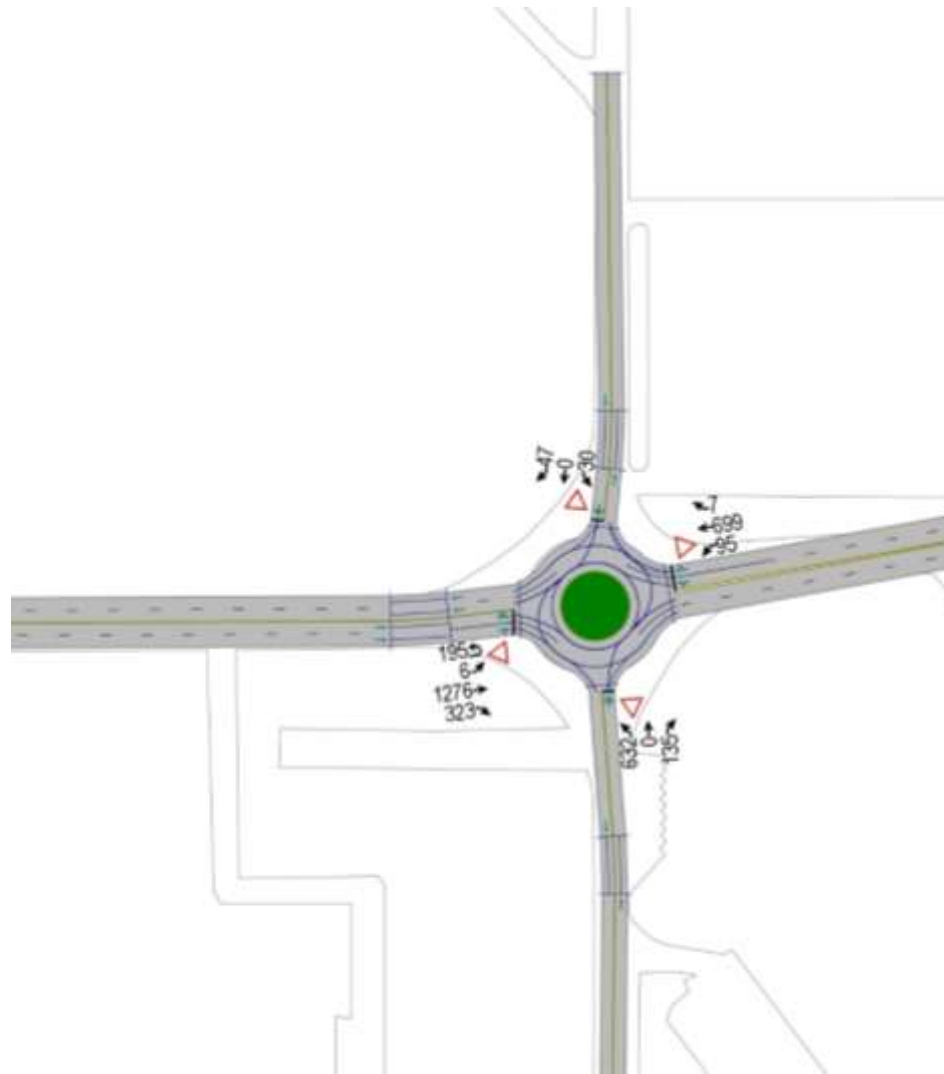
Figura 95: Situação da malha viária e volumes no período da manhã – Trecho 1 - Cenário 01.
