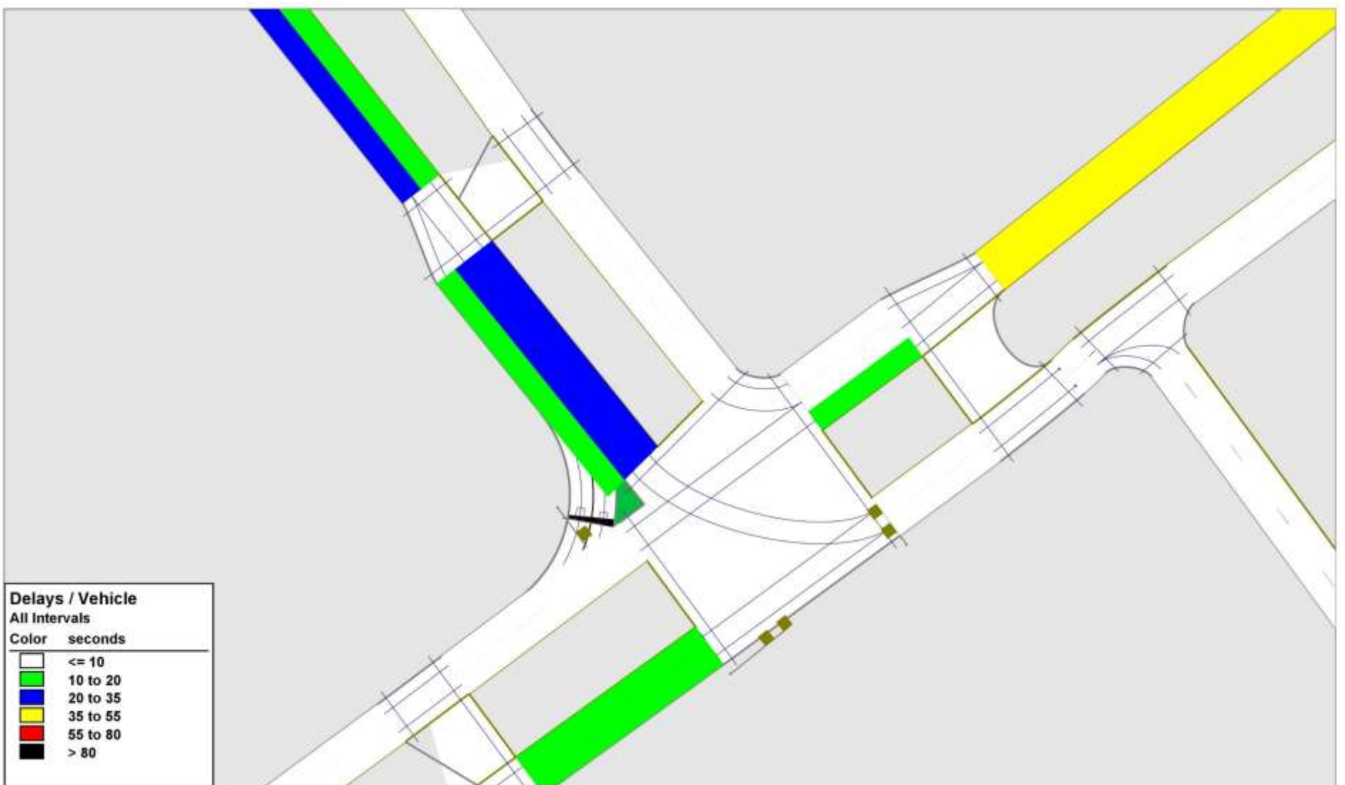
Figura 143: Atrasos nas aproximações com a mitigação implantada no período da tarde – trecho 04 - Cenário 03.
