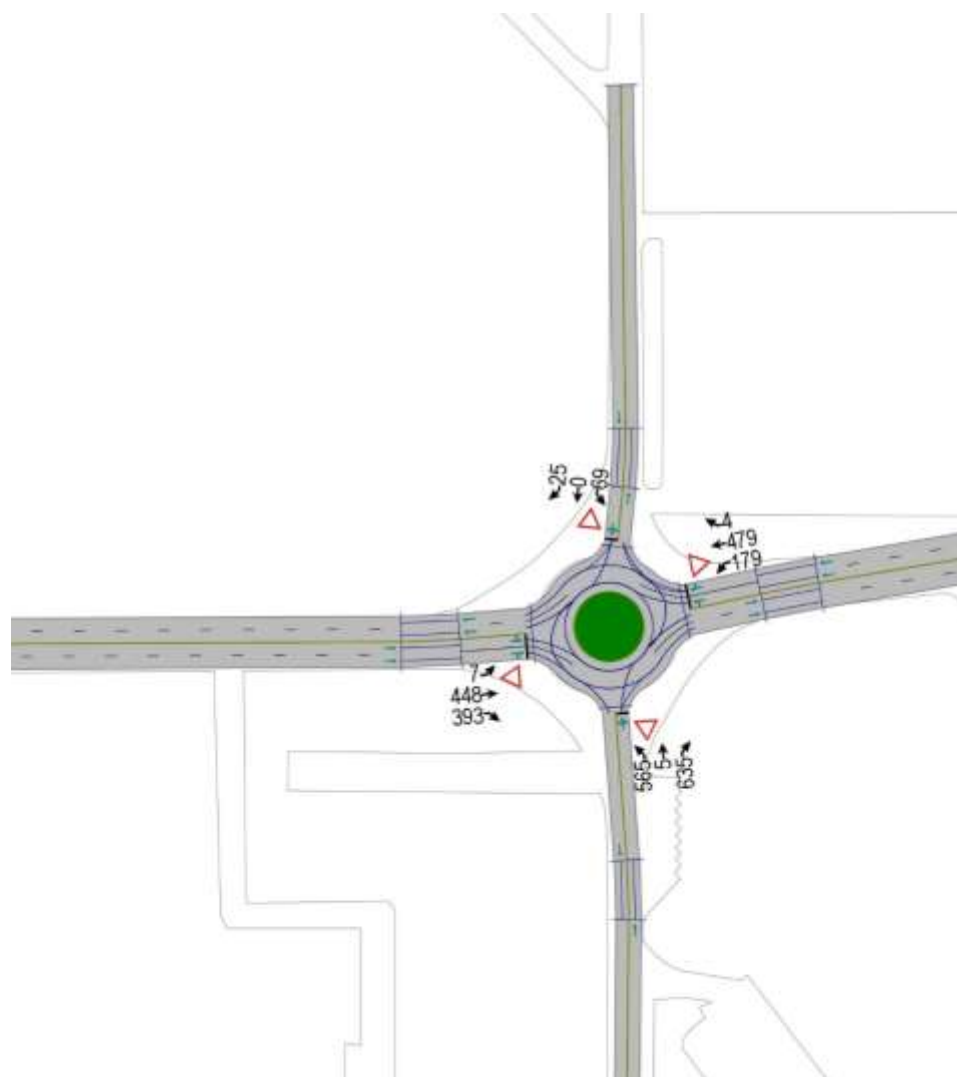
Figura 96: Situação da malha viária e volumes no período da tarde – Trecho 1 - Cenário 01.
