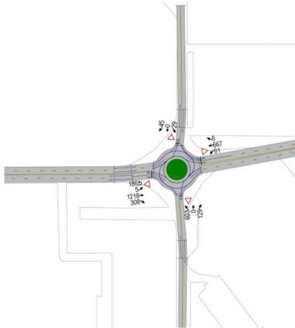
Figura 76: Situação da malha viária e volumes no período da manhã – Trecho 1 - Cenário 00.
