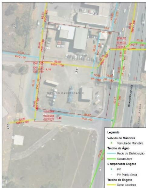
Fig.12. Croqui de Interferência de redes de água e esgoto. Fonte: CAESB
