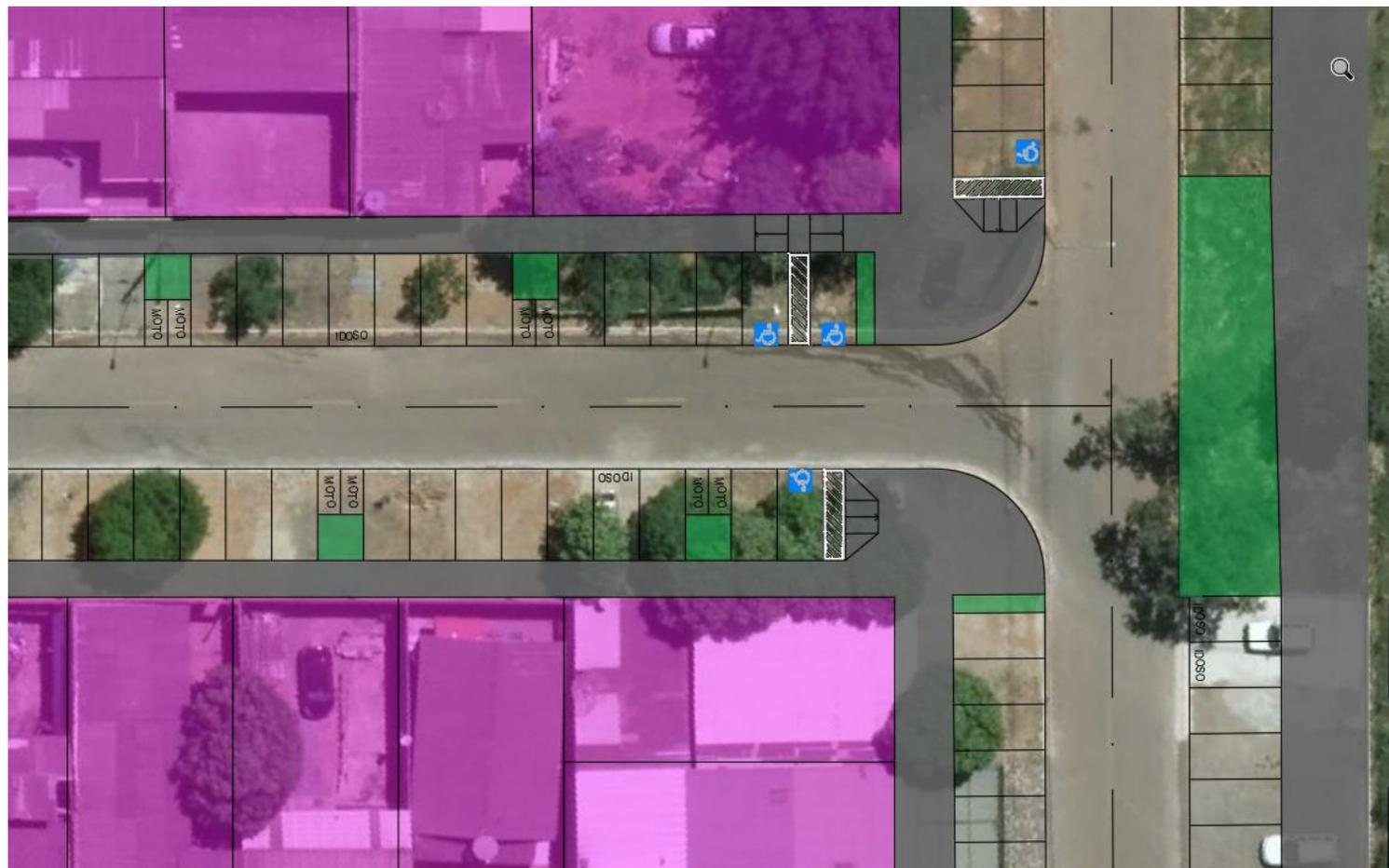
O sistema viário foi complementado com vistas a regularizar as vias implantadas, e foram reconfiguradas as vagas de estacionamento e calçadas de forma a abrigar a arborização do setor. A indicação de arborização visa mitigar os riscos ambientais envolvidos de perda de área de recarga de aquífero e risco de contaminação do subsolo, indicados no ZEE, bem como a ausência de cerrado nativo. Dessa forma, devem ser utilizadas prioritariamente espécies de cerrado nativo ou bem adaptadas ao clima.
