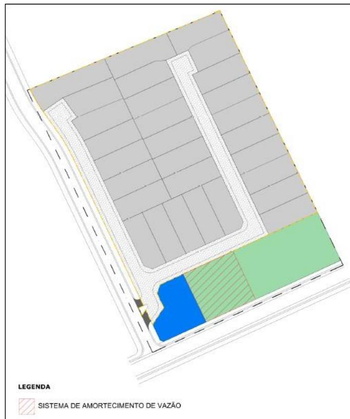
Figura 4 - Croqui do Sistema de Amortecimento de Vazão
