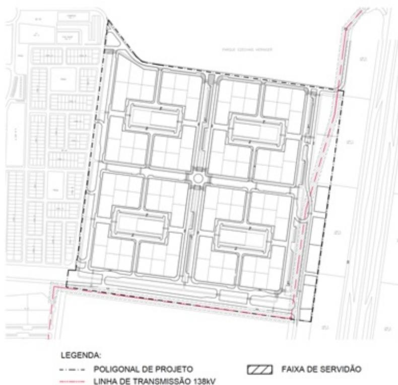
**Figura 23:** Mapa de interferência com Rede de Distribuição de Energia Elétrica.
