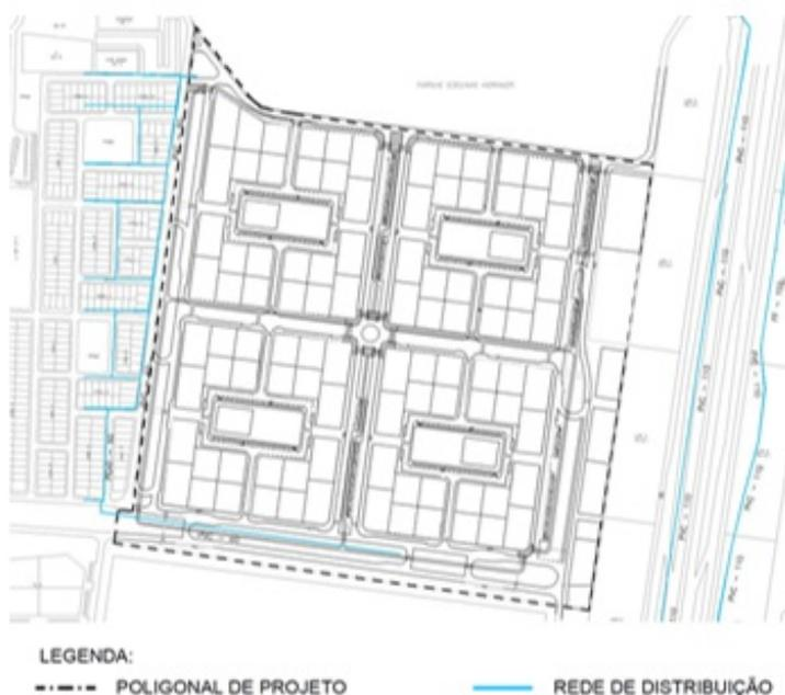
**Figura 22:** Mapa de interferência com Sistema de Abastecimento de água.
