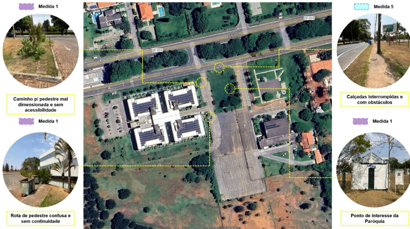
Figura 10: Indicação dos pontos de interesse observados em vistoria, parte 1.
