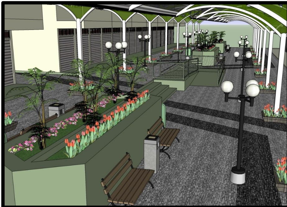
Figura 4- Nesta imagem, podemos visualizar as escadas e rampas de acesso que objetivam compensar o desnível existente entre as lojas e parte da área pública. Também é possível ver com maior detalhe o trabalho do piso em pedra portuguesa, nas cores preto e cinza. Fonte: Arquivos da Dilest.
