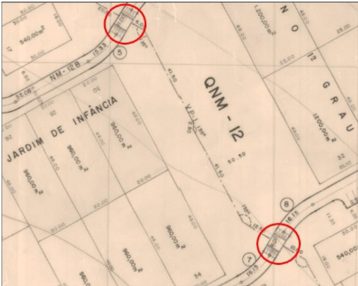
**Figura 23:** Detalhe da Planta Registrada - PR 903/1 em que mostra a travessia de pedestres do tipo "*traffic calming*", Mapoteca/SEDUH
