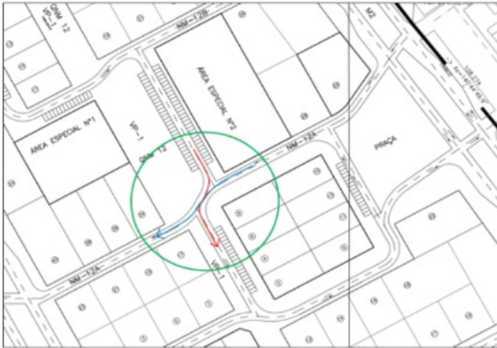
Figura 3: Entrelaçamento entre a via NM 12A e via de ligação entre as vias NM 12B e NM 12A, detalhe da URB-099/01 (TERRACAP)"
