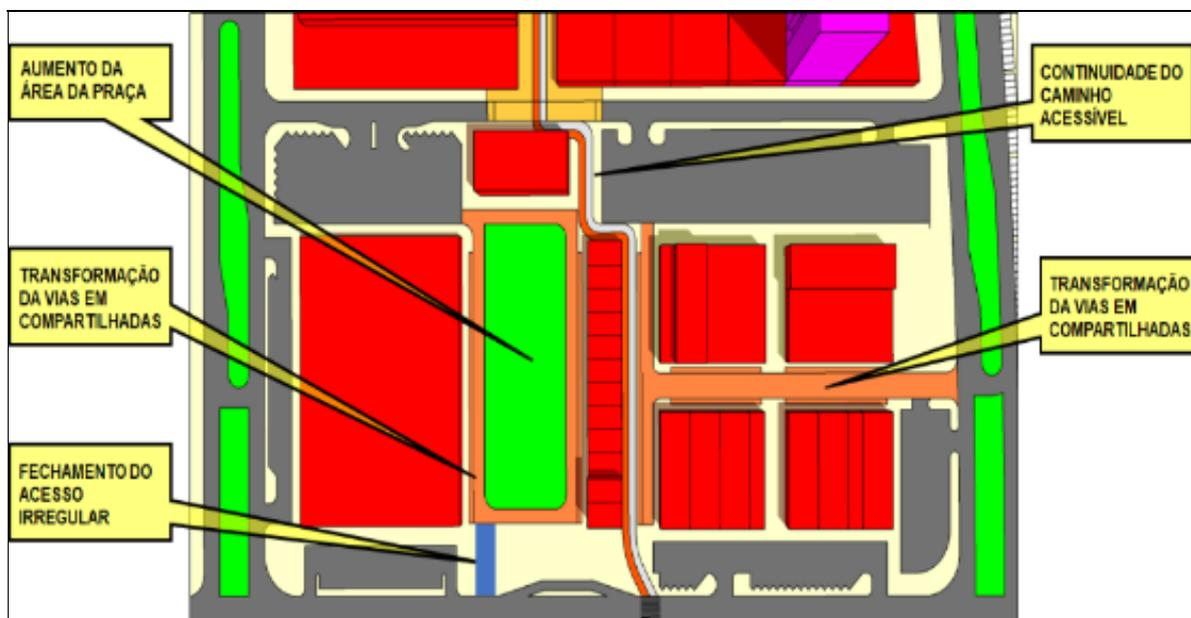
**Figura 32:** proposta de intervenção na praça e nas vias e internas, montagem DIOEST sobre base SICAD com o uso do software Sketchup
