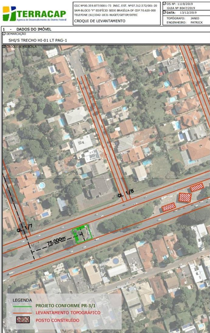
**Figura 3:** Croqui de levantamento da área, com a indicação do Lote Registrado (verde) e Levantamento Topográfico da edificação construída (vermelho). Fonte: Terracap, Doc. Sei Nº 34821766, Processo SEI nº 00111-00000754/2020-18
