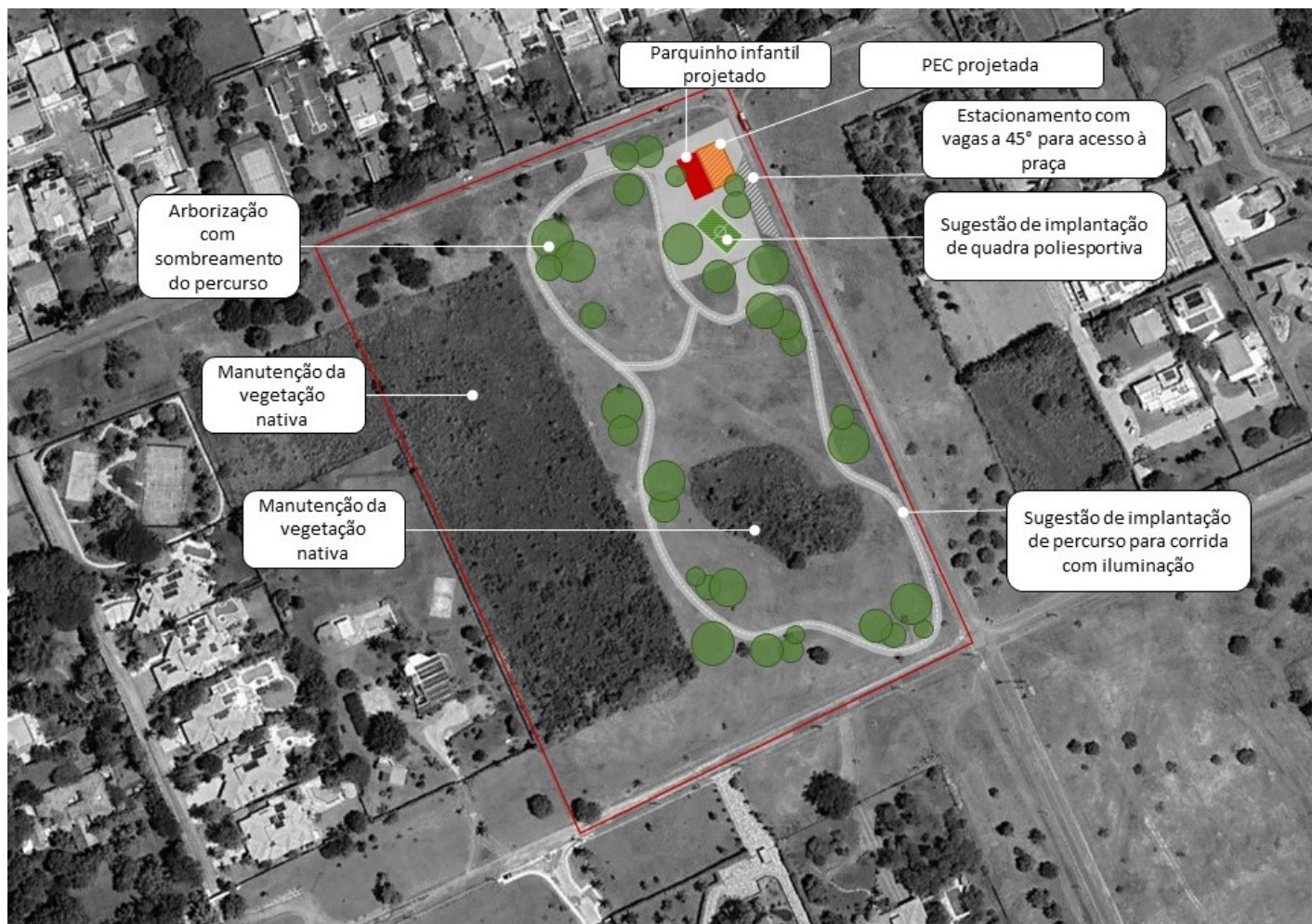
Figura 9: Sugestões para intervenção com base nas Diretrizes de Projeto propostas pela DICAD I para a Praça. Fonte: DICAD I /SEDUH
