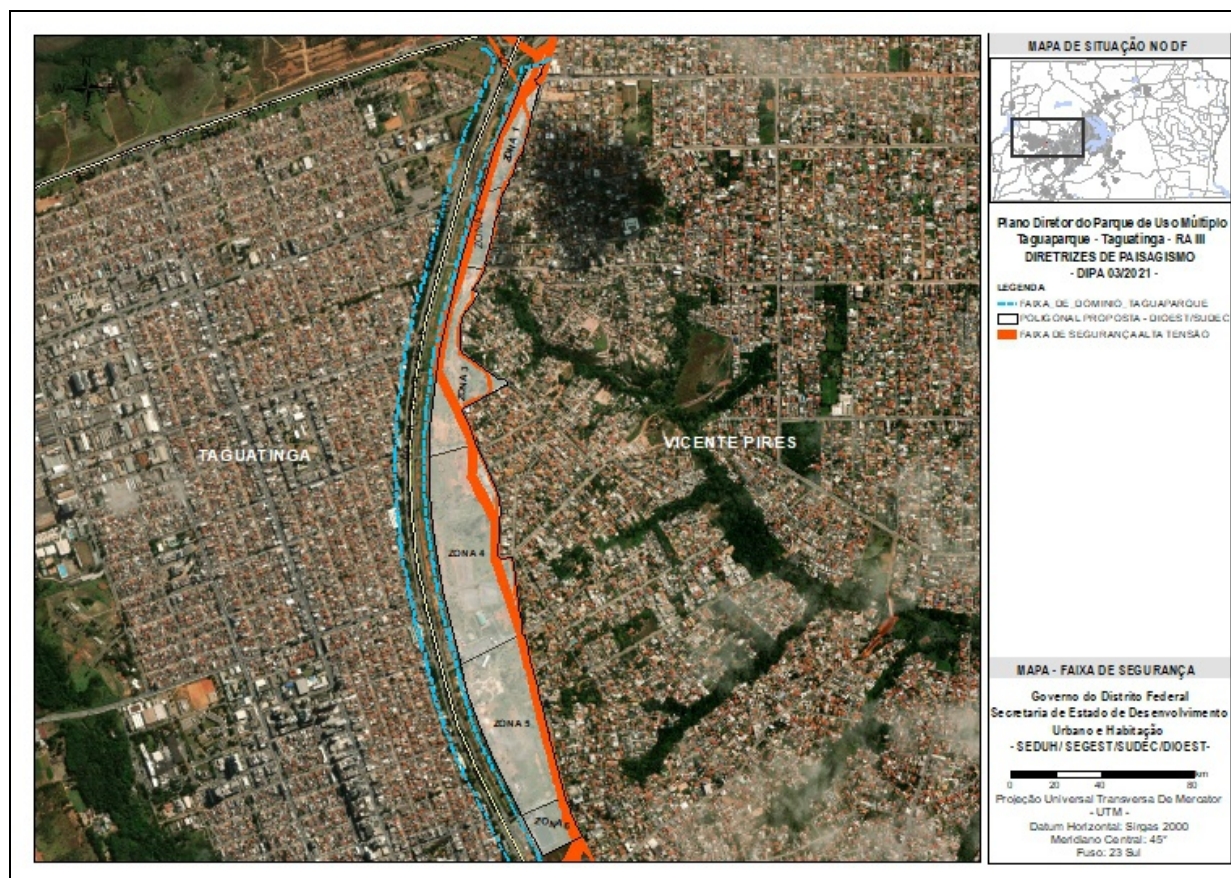
Figura 26. Interferência de rede de alta tensão no Taguaparque. Fonte: SUDEC/DIOEST.
