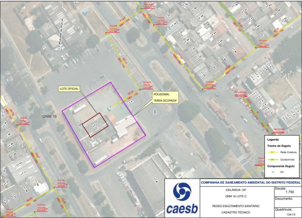
Figura 6 - Interferência com a REde de Esgotamento Sanitário.
