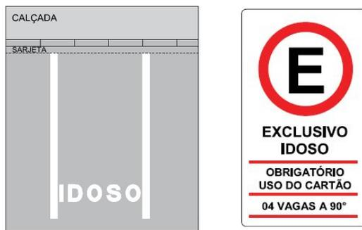
Fig. 02 - Sinalização horizontal, em vaga perpendicular ao meio-fio, e exemplo de sinalização vertical para estacionamento de idosos. Fonte: Resolução CONTRAN nº 303/2008, Anexo I
