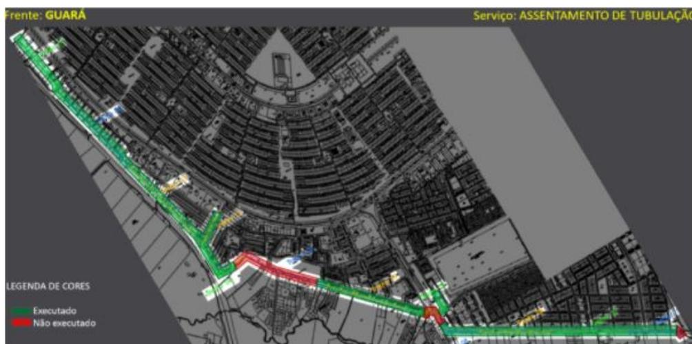
Figura 2: Obras incompletas de substituição de tubulações, próxima à Avenida de Contorno. Fonte: Nota Técnica 22/2017
