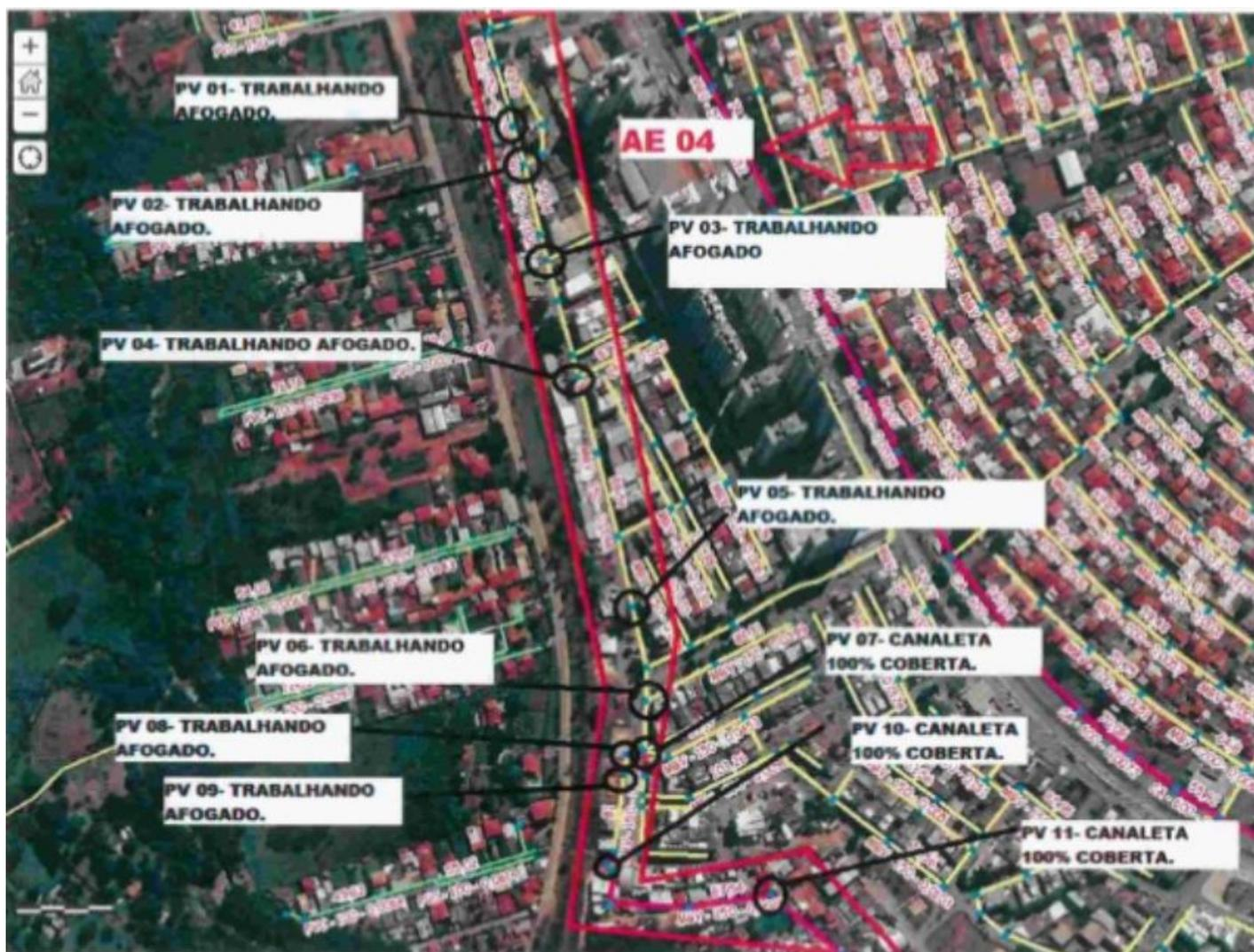
Figura 3: Levantamento da capacidade de esgotamento sanitário na AE 02 e 04, Guará II. Fonte: CAESB.
