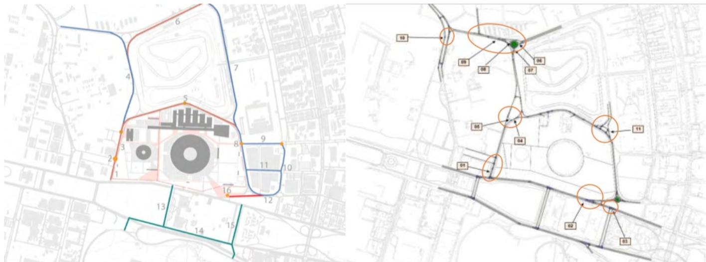
Fig. 3 - Indicações das alterações necessárias para adequação para melhoria do fluxo de pedestres e ciclistas (medidas 3 - marrom, 4 - azul, 5 - verde e 6 - vermelho). Fonte: EIV versão 4.1 (54708098), pág. 152.
