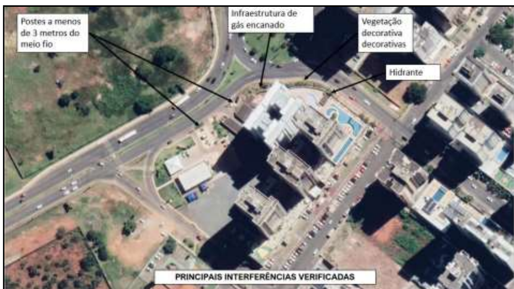
Fig. 09 - interferências identificadas no local pela Nota técnica.
