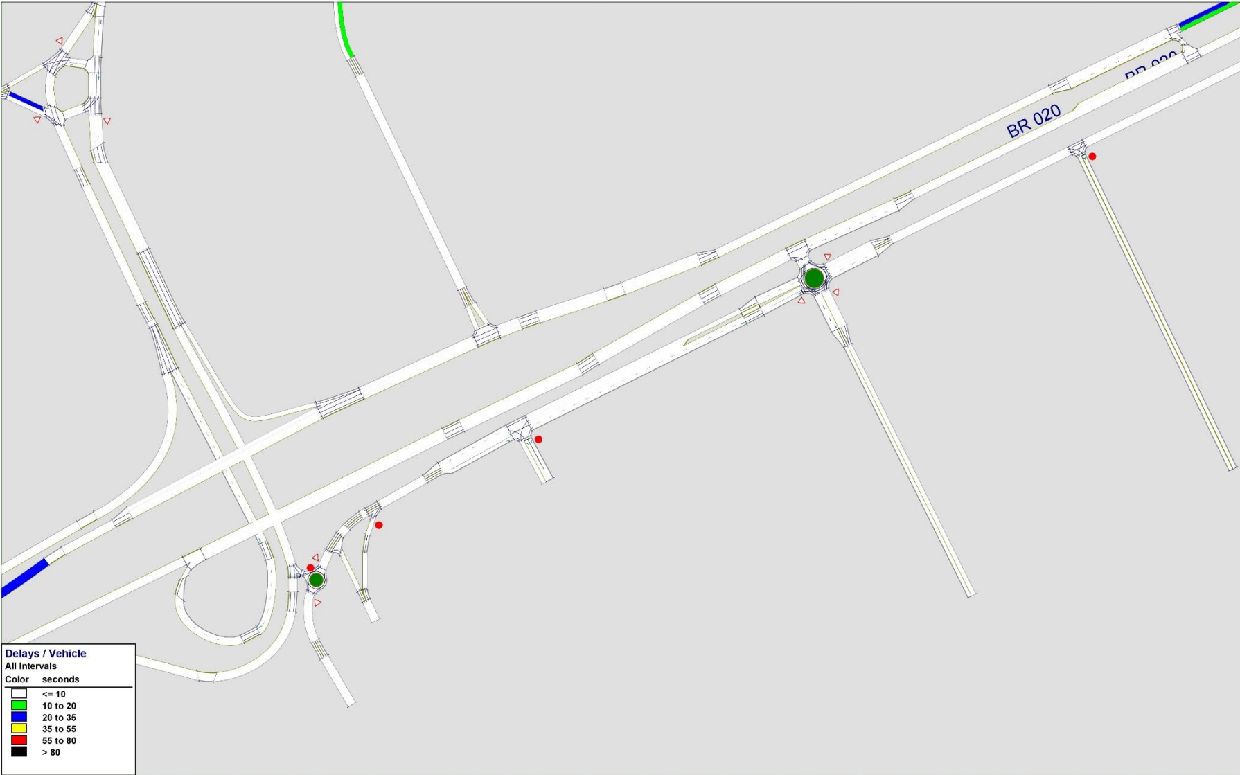
Atrasos nas aproximações com o empreendimento instalado no período da manhã
