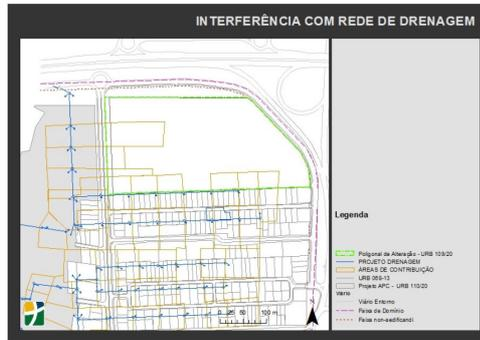
Figura 10 - Interferência do projeto de drenagem com a Poligonal de projeto
